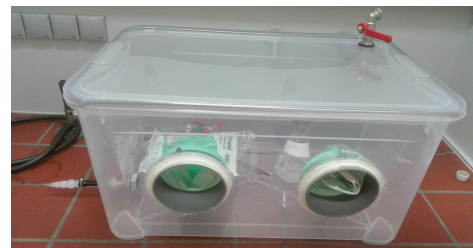
2 selbstgebaute, einfache Glovebox
